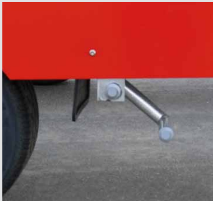
Hebel zum Entriegel der Auffahrampen
