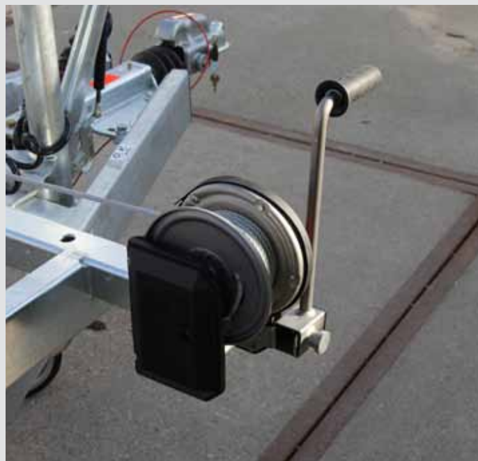
Seilwinde für leichtes beladen
