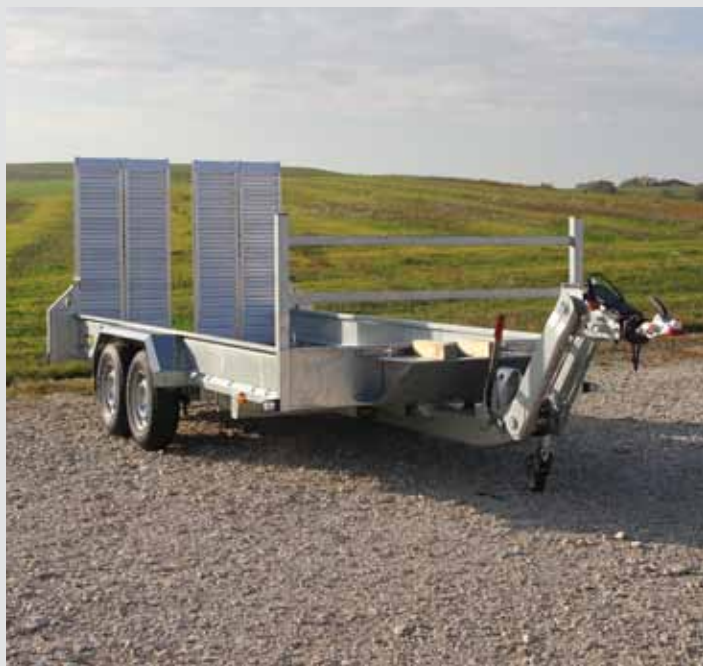
höhenverstellbare Zugdeichsel, zusätzliche Auffahrampen
