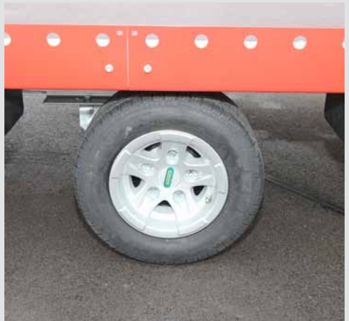
10 Zoll Bereifung für eine niedrige Beladehöhe
