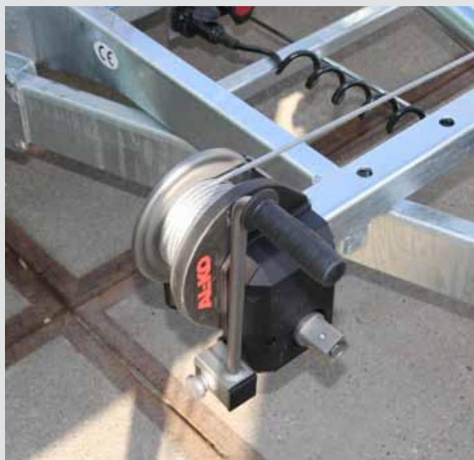
Seilwinde für leichtes beladen
