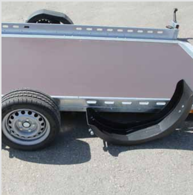
Kotflügel komplett abklappbar
