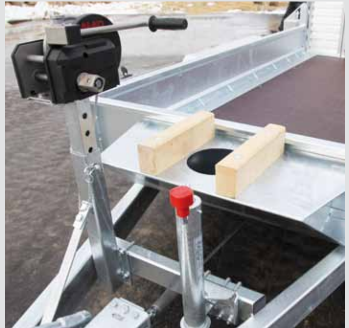
Baggerarmauflage, Windenbock mit Handseilwinde
