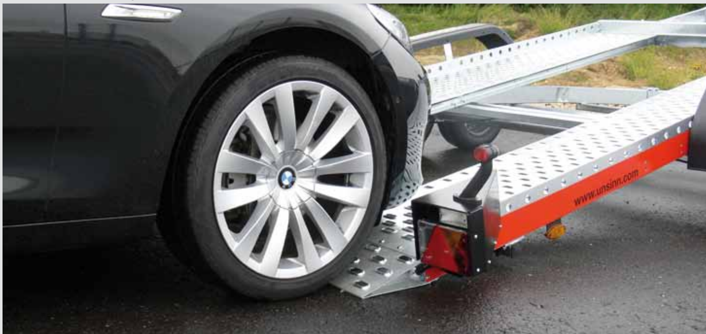
geringer Auffahrwinkel für Fahrzeuge mit wenig Bodenfreiheit
