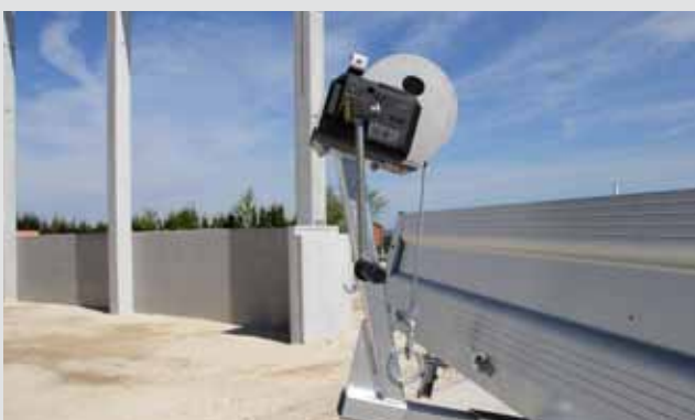
Seilwinde auf geschweißtem Windenbock
