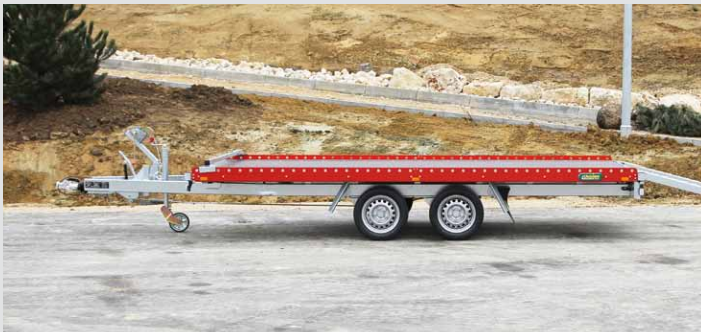
Reling mit Zurrpunkten für flexible Ladungssicherung
