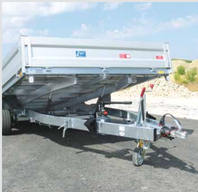
verschweißter und feuerverzinkter Stahlrahmen
