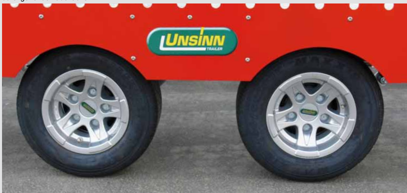
10 Zoll Bereifung für eine niedrige Ladehöhe
