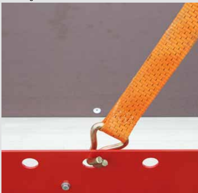
Zurpunkte in der Seitenreling mit 400 kg belastbar
