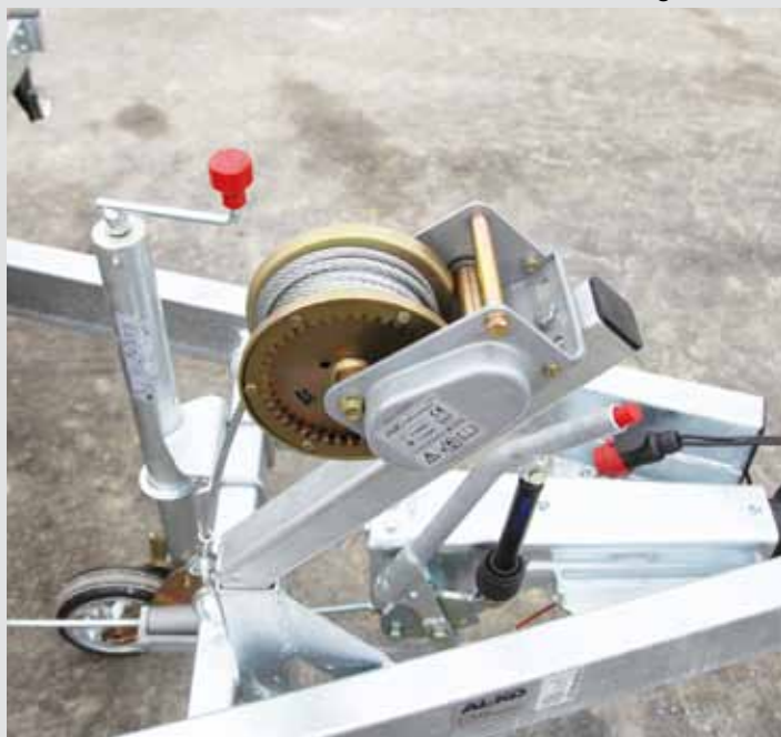
Handseilwinde mit 900 kg belastbar
