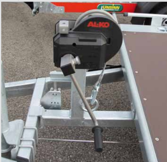
Seilwinde auf Windenbock montiert
