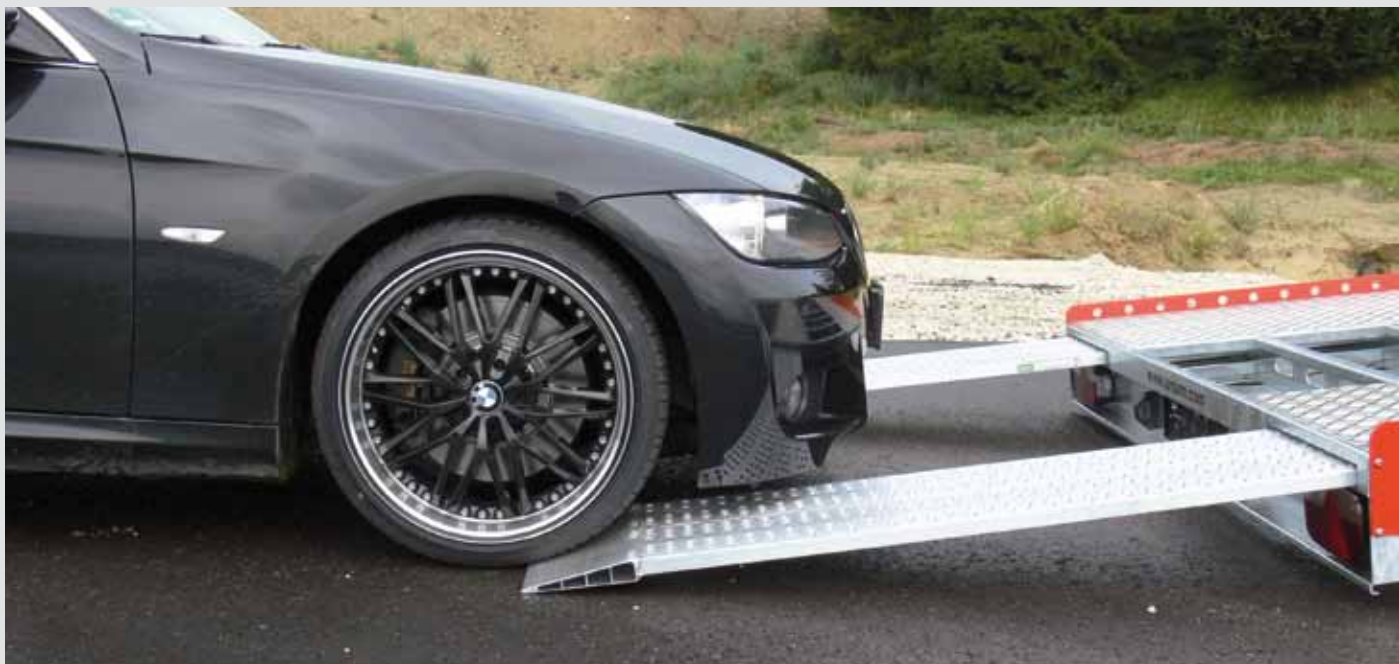
geringer Auffahrwinkel für Fahrzeuge mit wenig Bodenfreiheit
