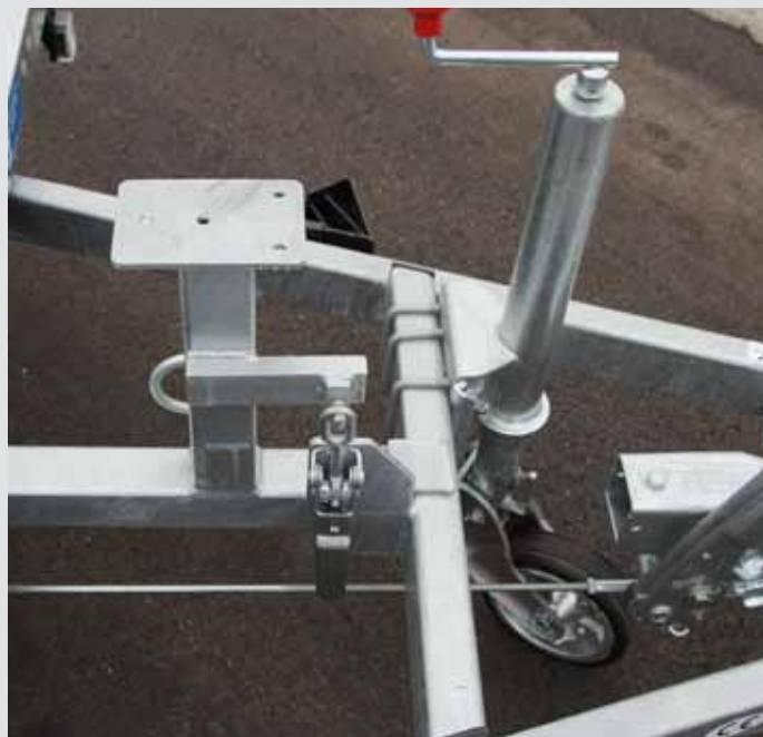
Windenbock mit Sicherungshebel
