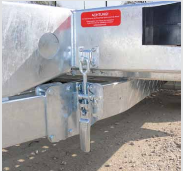
Sicherungsverchluss der Abklappfunktion
