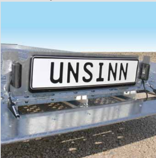
Kennzeichenhalter ausgeklappt für die Fahrt
