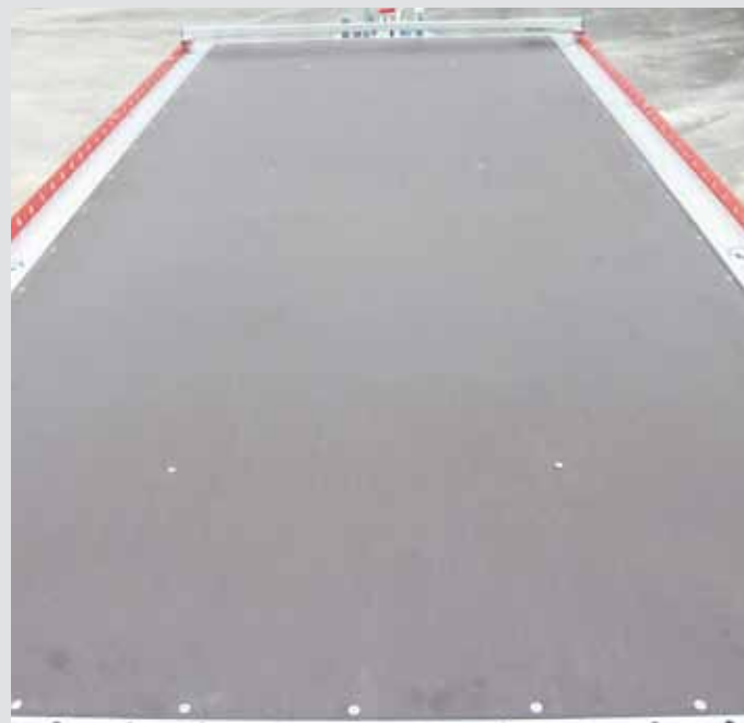
durchgehende Bodenplatte ohne Stöße
