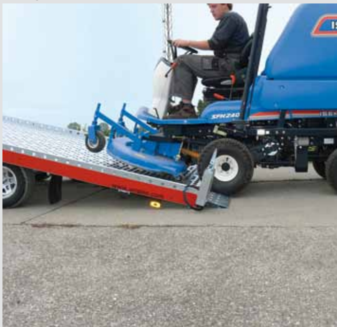
geringer Auffahrwinkel für leichtes Befahren
