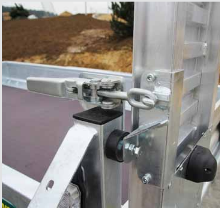
Spannverschluss der Auffahrampen
