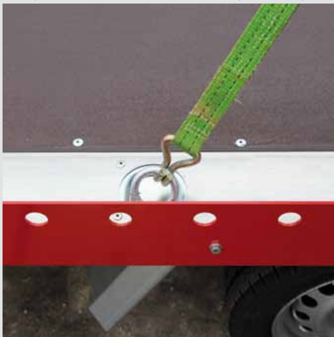
Zurpunkte in der Ladefläche mit 600 kg belastbar
