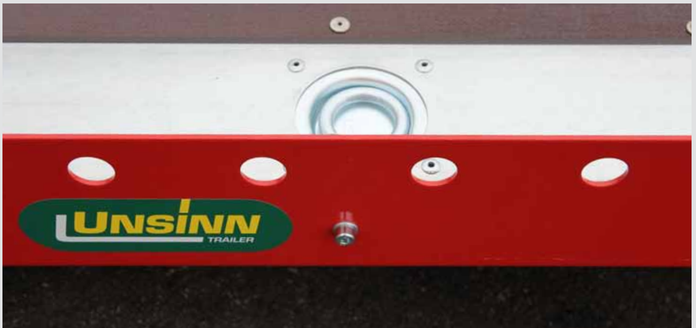
Zurrgunkte an der Reling mit 400 kg Zugkraft
