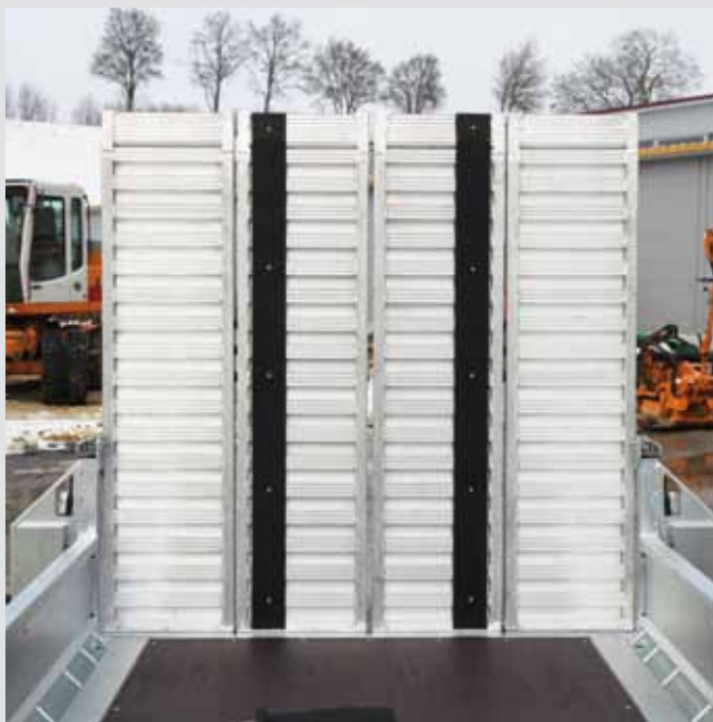
durchgehende Auffahrampen mit Gummiauflage
