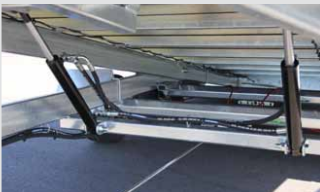
Hydraulik doppelwirkend und mit zwei Zylindern
