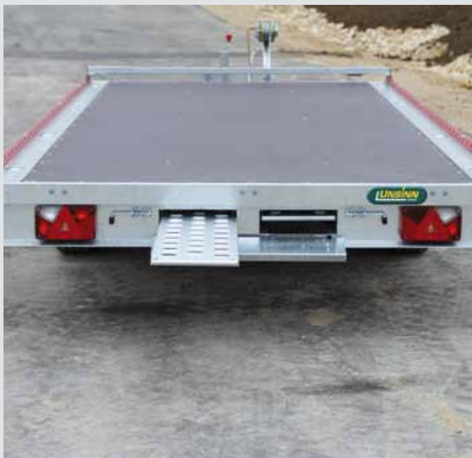
Halteungen für Auffahrschienen unter der Ladefläche
