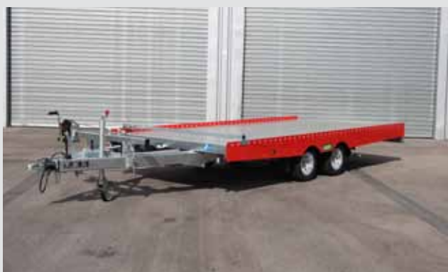
verschweißter und feuerverzinkter Stahlrahmen
