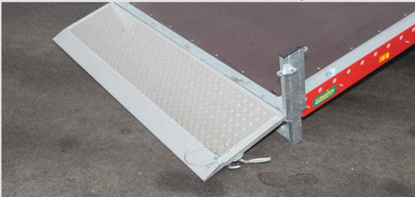
durchgehende Auffahrklappe mit rutschhemmendem Riffelblech
