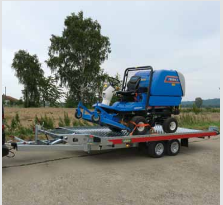
verschweißter und feuerverzinkter Stahlrahmen
