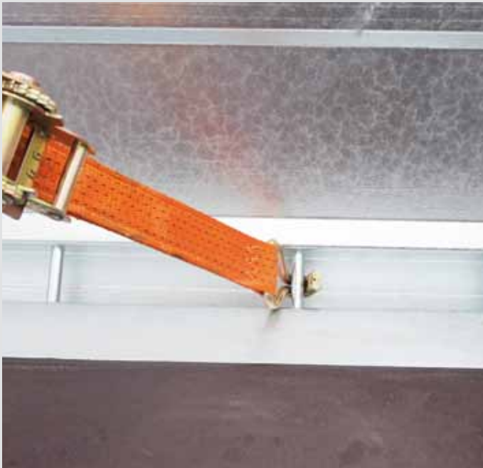
Zurrgpunkt mit 2000 kg Zugkraft
