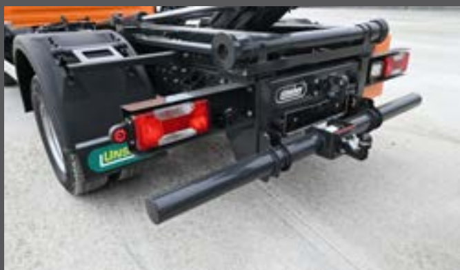
Heckunterfahrerschutz mit Kugelkopfkupplung
