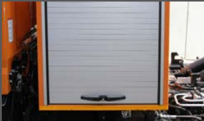
Systemschrank hinter dem Fahrerhaus
