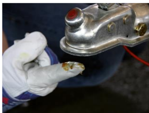
Bild: Kugelschale fetten
