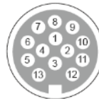
13-poliges System DIN / ISO 11446
