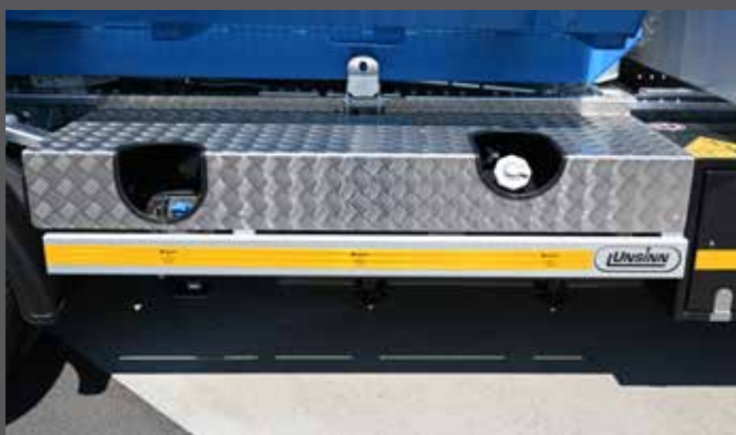
Schutzabdeckung über dem Tank
