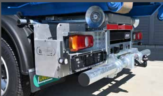
Heckunterfahrerschutz mit Kugelkopfkupplung
