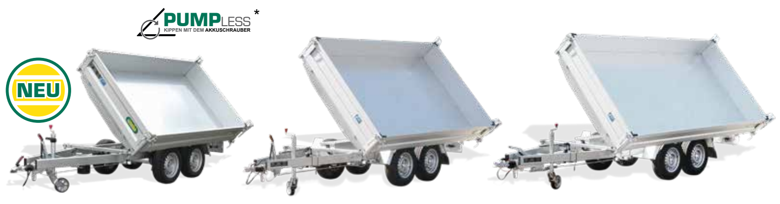
Dreiseitenkipper Typ UDK 2627-14-1500 Stahlboden und Winkelhebelverschlüsse, Pumpless Hydraulik Kastenmaße innen: L/B/H 2760 x 1500 x 350 mm zGG*: 2600 kg Nutzlast: ca. 1960 kg Bereifung: 185/65 R14 Dreiseitenkipper Typ UDK 3030-14-1750 Stahlboden und Winkelhebelverschlüsse, Elektro-Hydraulik, Nothandpumpe Kastenmaße innen: L/B/H 3060 x 1750 x 350 mm zGG*: 3000 kg Nutzlast: ca. 2310 kg Bereifung: 185 R14C 8PR Dreiseitenkipper Typ UDK 3536-14-1750 Stahlboden und Winkelhebelverschlüsse, Elektro-Hydraulik, Nothandpumpe Kastenmaße innen: L/B/H 3660 x 1750 x 350 mm zGG*: 3500 kg Nutzlast: ca. 2630 kg Bereifung: 185 R14C 8PR
