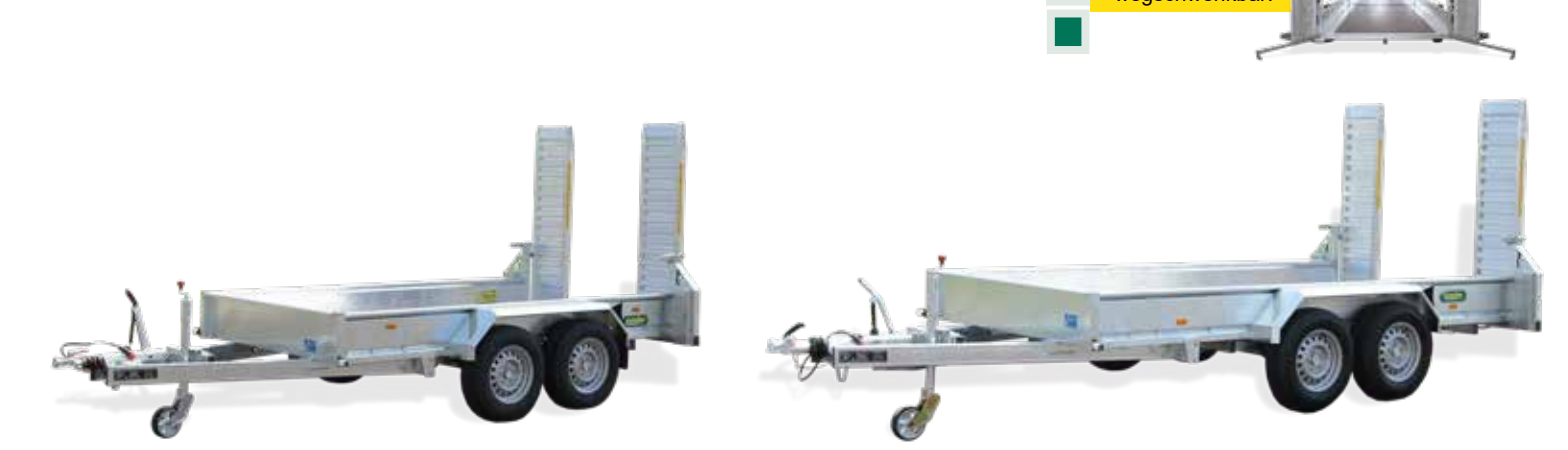
Baumaschinenanhänger Typ UBA 3030-14-1600 Kastenmaße innen: L/B/H 3060 x 1600 x 300 mm zGG*: 3000 kg Nutzlast: ca. 2380 kg Bereifung: 185 R14C 8PR Baumaschinenanhänger Typ UBA 3536-14-1800 Kastenmaße innen: L/B/H 3660 x 1800 x 300 mm zGG*: 3500 kg Nutzlast: ca. 2730 kg Bereifung: 185 R14C 8PR
