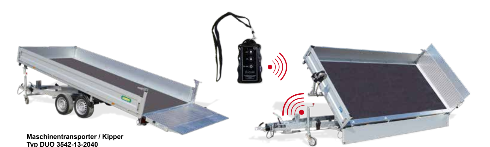
Maschinentransporter / Kipper Typ DUO 3542-13-2040 Windenbock, Elektrohydraulik, Funkfernbedienung Kastenmaße innen: L/B/H 4260 x 2040 x 350 mm zGG*: 3500 kg Nutzlast: ca. 2410 kg Bereifung: 195/50 R13C
