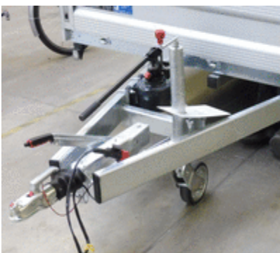
Bild: Maschinentransporter mit Kippfunktion
