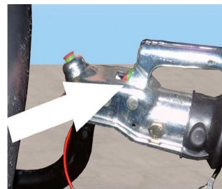
Bild: Verschleißanzeige Kugelpkupplung
