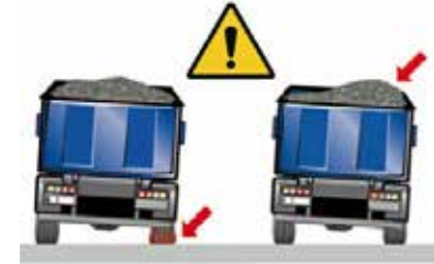
Ungleicher Reifendruck / Einseitige Verteilung der Ladung
