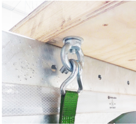
Zurröse für 350 daN Zurrkraft in der Bodenplatte verankert
