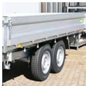
Erhöhte Anzahl an Bordwandscharnieren für mehr Stabilität der Bordwand beim Transport von Schüttgütern
