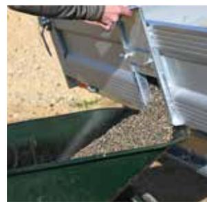
Kornschieber in der Heckbordwand für dosiertes Abladen
