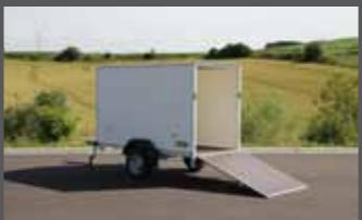
Einachs Plywood-Kofferanhänger mit Klappe
